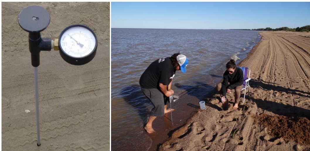
Figura 19: Ensaio de compactação com uso de penetrômetro manual (foto a esquerda)
