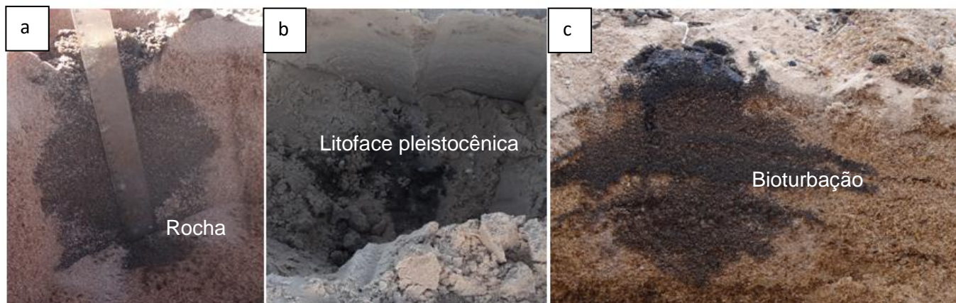
Figura 30: Camada de sedimentos heterogênea; A) camada de rocha na profundidade de 30 cm. B) litoface pleistocênica impermeável em 35 cm; C) Bioturbação provocada por animais e restos vegetais em camadas superficiais.
