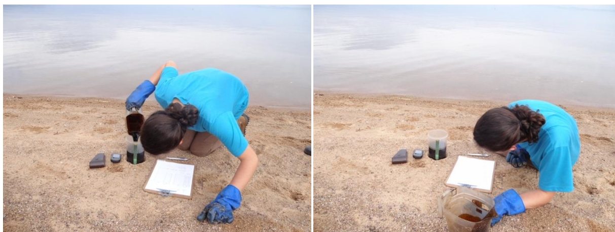
Figura 16: Em cada ponto foram inseridos 750 ml de petróleo, sendo anotado, em planilha, o tempo necessário para todo o fluido infiltrar no substrato. Foram anotadas, em planilha, as variações de tempo necessárias para cada variação de cinco milímetros no nível.
